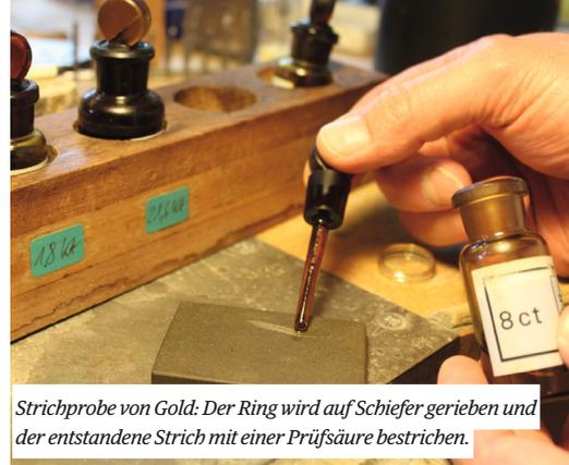
Strichprobe von Gold: Der Ring wird auf Schiefer gerieben und der entstandene Strich mit einer Prüfsäure bestrichen.
